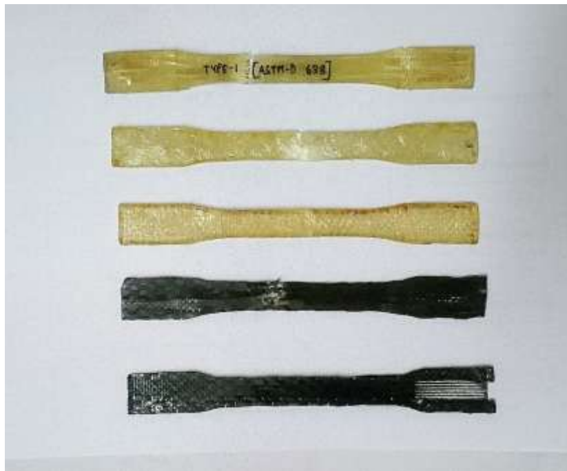
Fig. 8.8. Tested Specimens (Tensile Testing)
