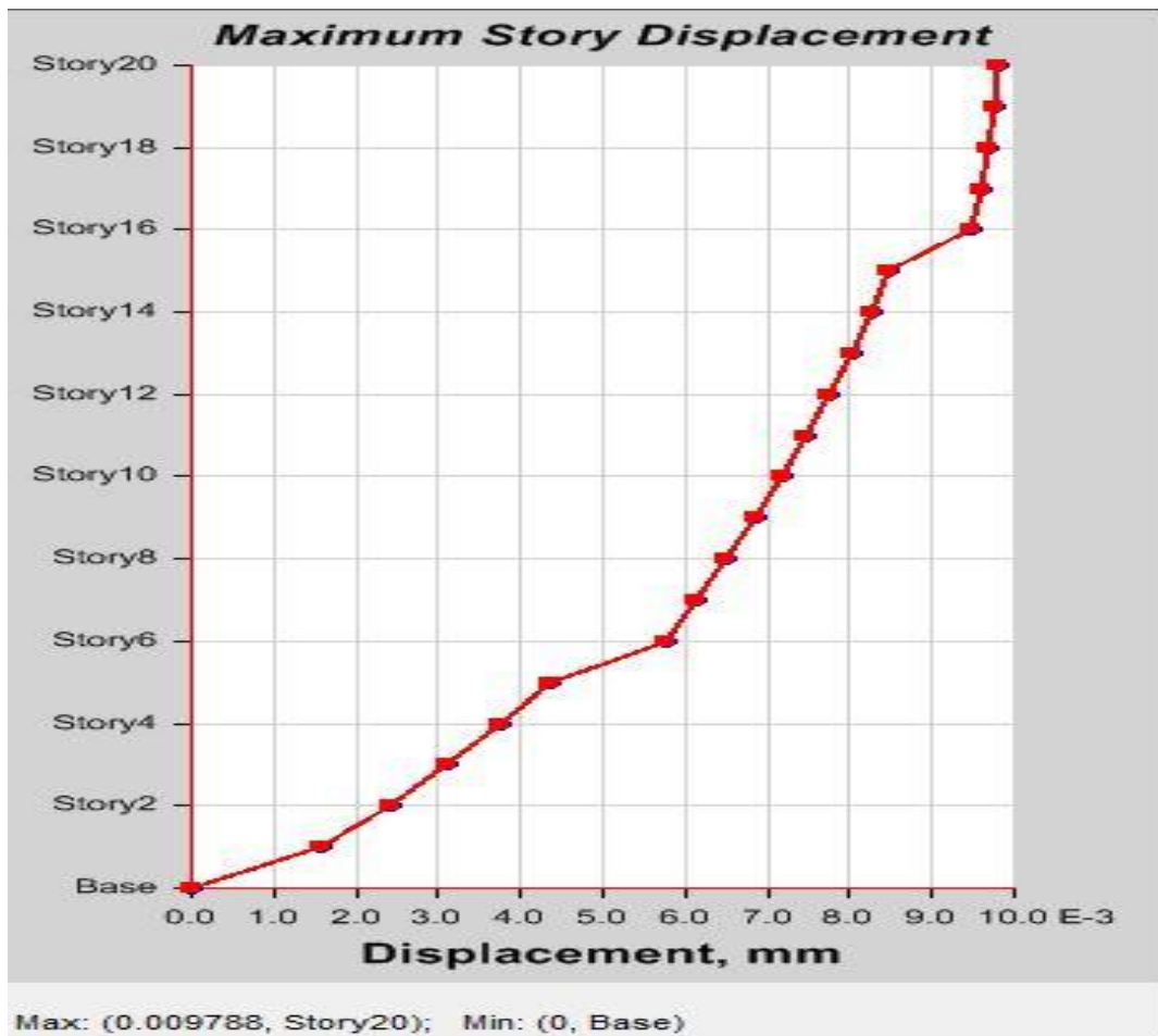
Fig: 5.21 Story Displacement
